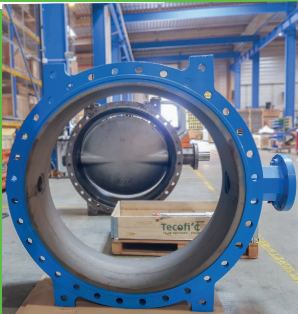
Дисковый поворотный затвор TECWAT Ду1200 Затвор с эпоксидным порошковым покрытием, нанесенным в печи, и затвор перед пескоструйной обработкой
